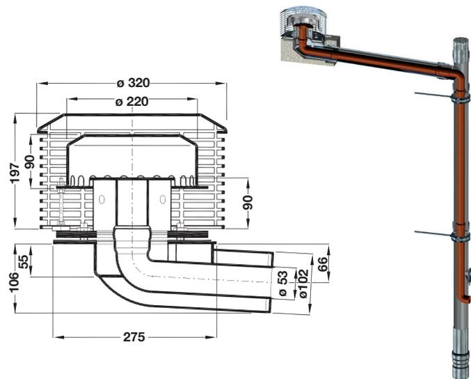
**LORO-Abzweig mit Bogen - Rohr in Rohr**
